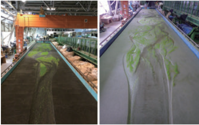
混合粒径（左）と一様粒径（右）における植生定着状況の比較実験
