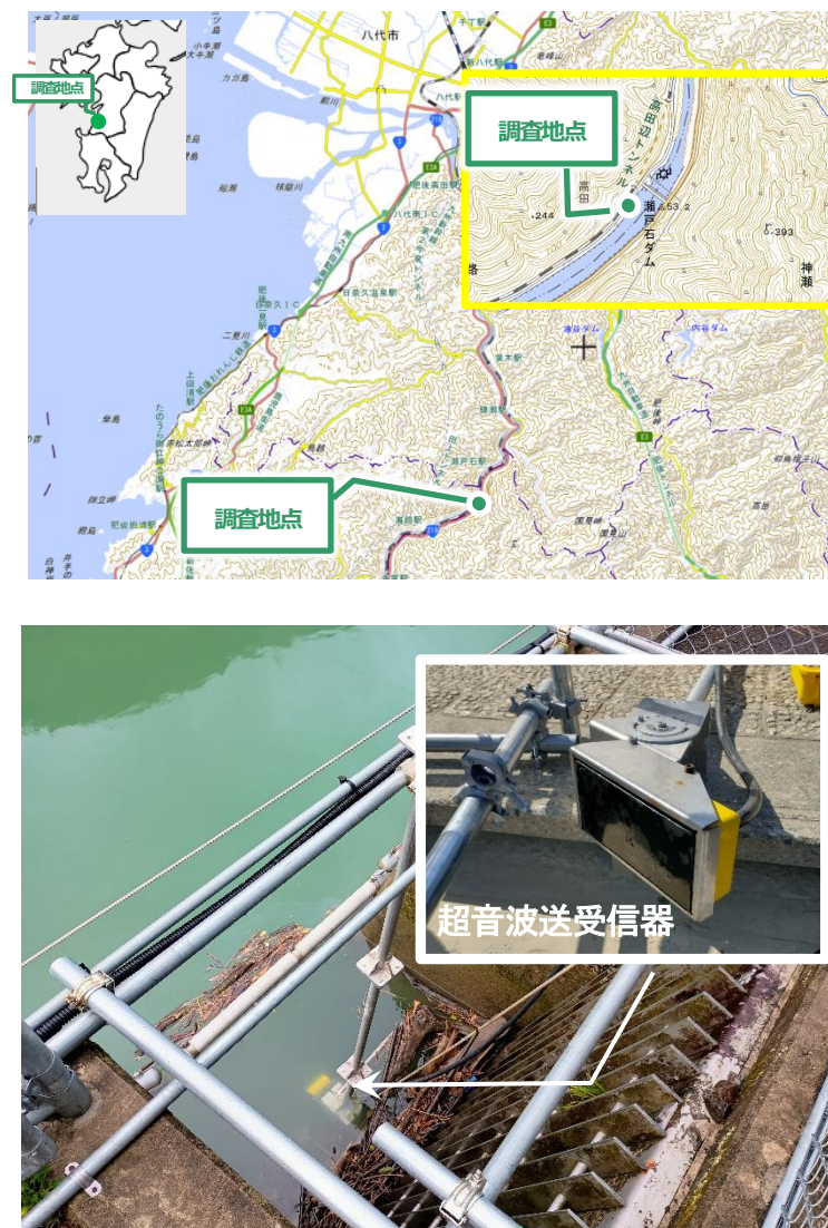
図-4.1 マルチビームソナーの設置状況（球磨川）
