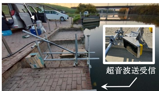
図-3.3 マルチビームソナー設置状況 (千歳川)
