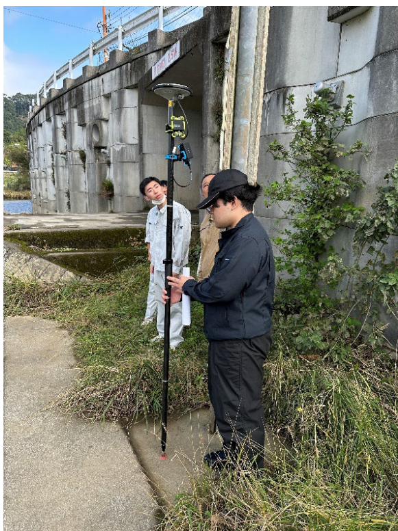
図5-7 RTK-GNSSによる基準点の測量
