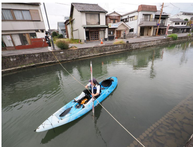
図2-9 掘割の簡易水深測量
