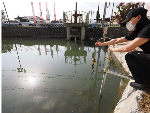
図2-6 塩分・水温・水位のモニタリング装置と二丁井樋前面への設置状況
