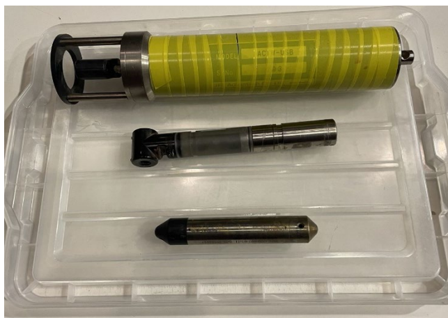
図2-6 塩分・水温・水位のモニタリング装置と二丁井樋前面への設置状況
