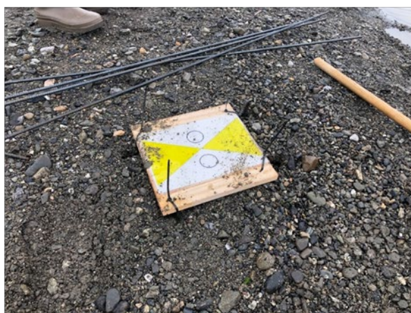
写真 1.1 覆砂領域の全景と設置した固定版の様子（2024 年 3 月 25 日）
