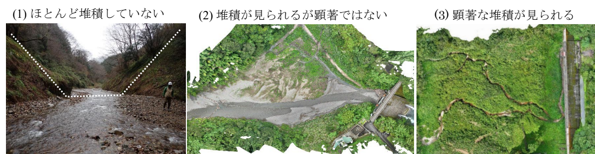
図 2.2 流水型ダム貯水池における細粒土砂の堆積状況（1:ほとんど堆積していない，2:堆積が見られるが顕著ではない，3:顕著な堆積が見られる）
