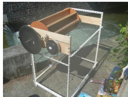
写真2. 5 水平羽根抗力型 木製平板羽根8枚羽根タイプ
