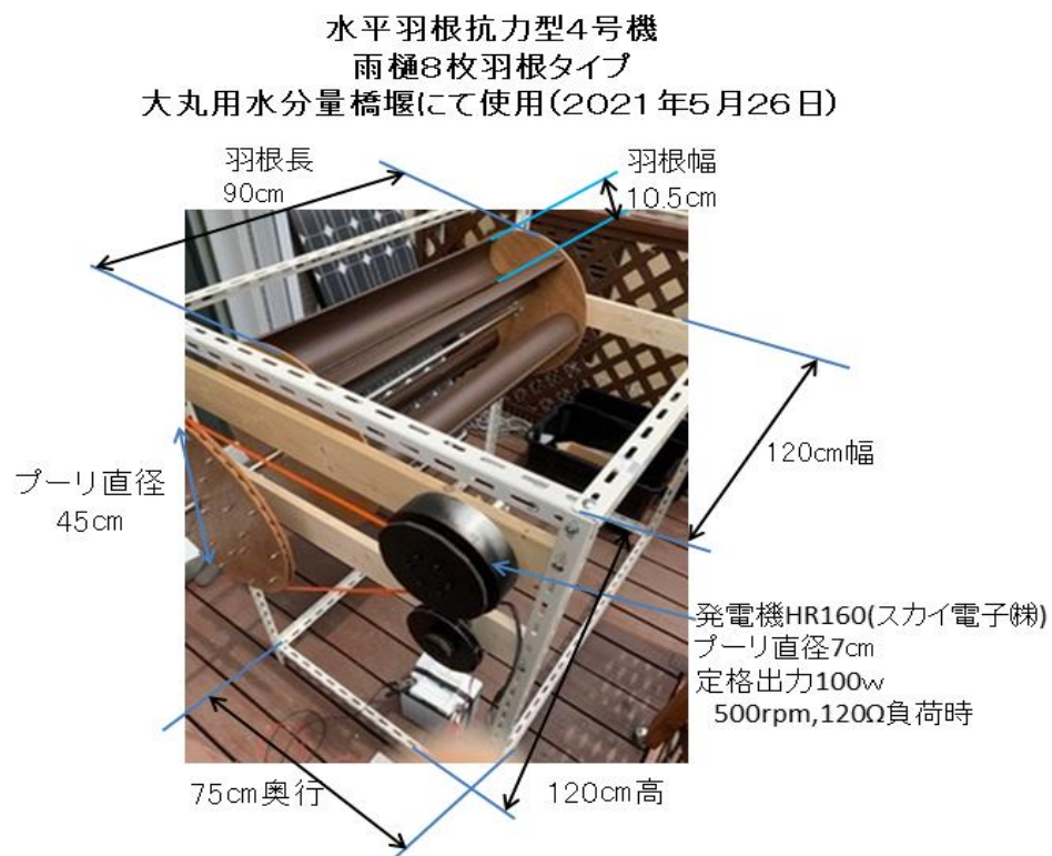
図2.6 手作り水車の構造
