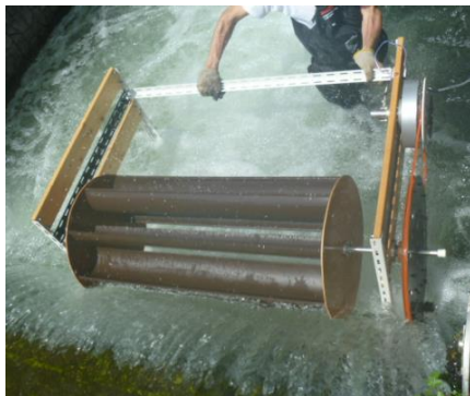
写真2. 4 水平羽根抗力型 雨樋8枚羽根タイプ
