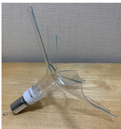
写真2. 28 ペットボトル発電 風車キットの羽根部分
