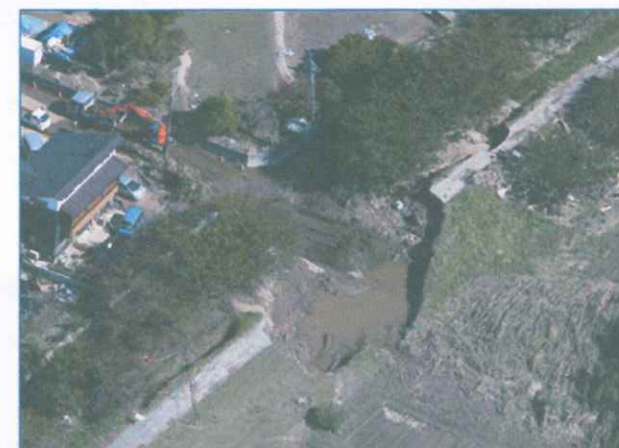
図5-5 夏井川平窪大念仏堤防決壊の様子 出展：2019.10.16 インターネットより
