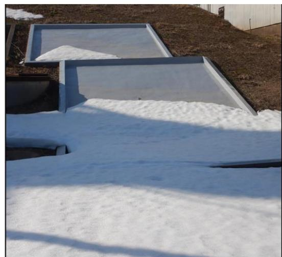
図 2-3 斜面ライシメータ(土木研究所雪崩・地すべり研究センター内)
