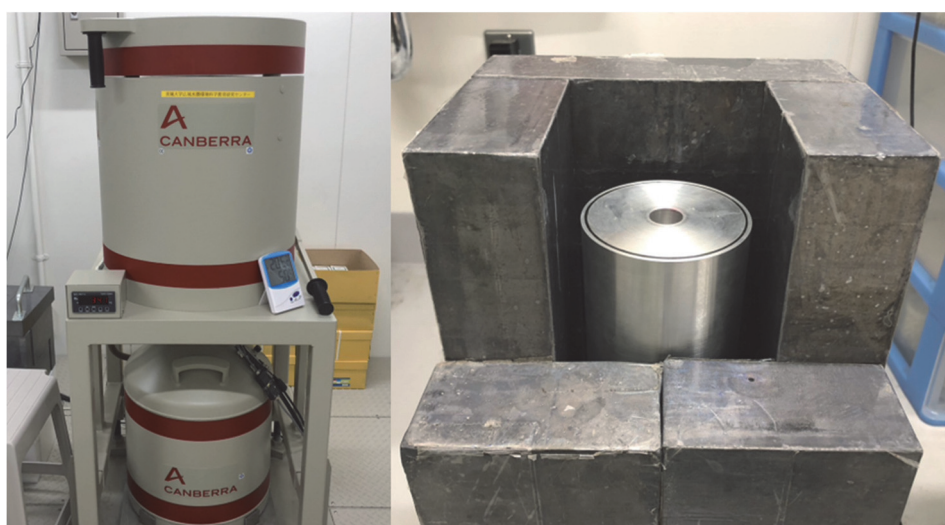
図 3.5 ゲルマニウム半導体検出器(左)およびウェル型 NaI シンチレーション検出器(右)。
