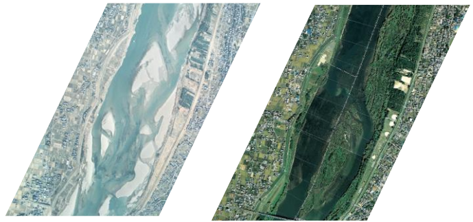
写真 1.1 木曽川での 1973 年から 2003 年の間に生じた樹林化
