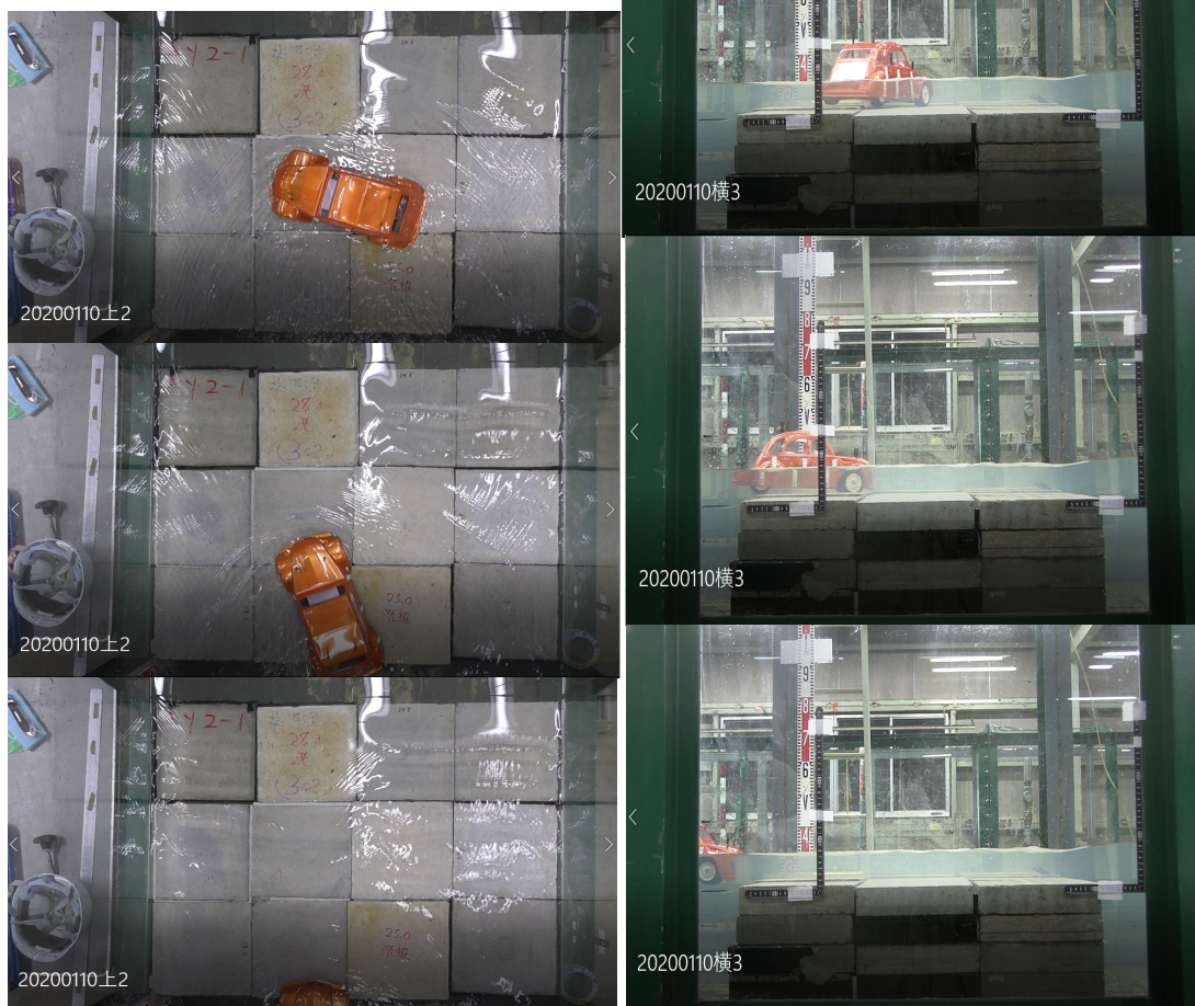
図 4-1 車両漂流実験（横向き 流量：0.020m 3 /s, 下流堰：27cm）の様子. 左段は上から, 右段は横から撮影した動画の一部.
