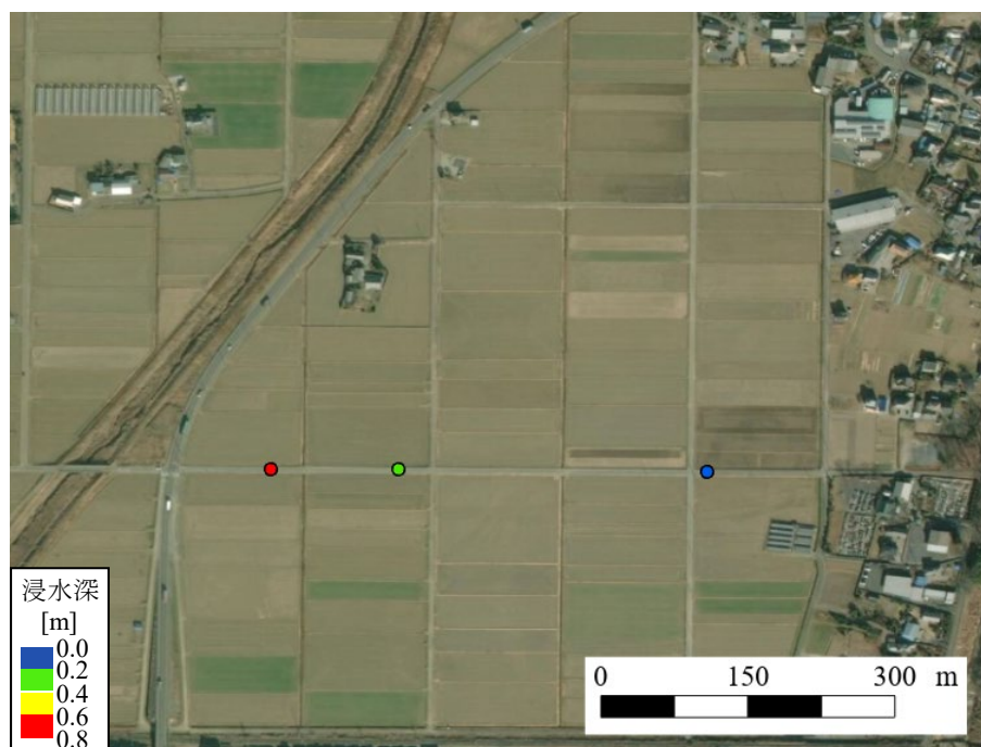
図 3-15 台風 19 号②の現場観測から取得した浸水深
