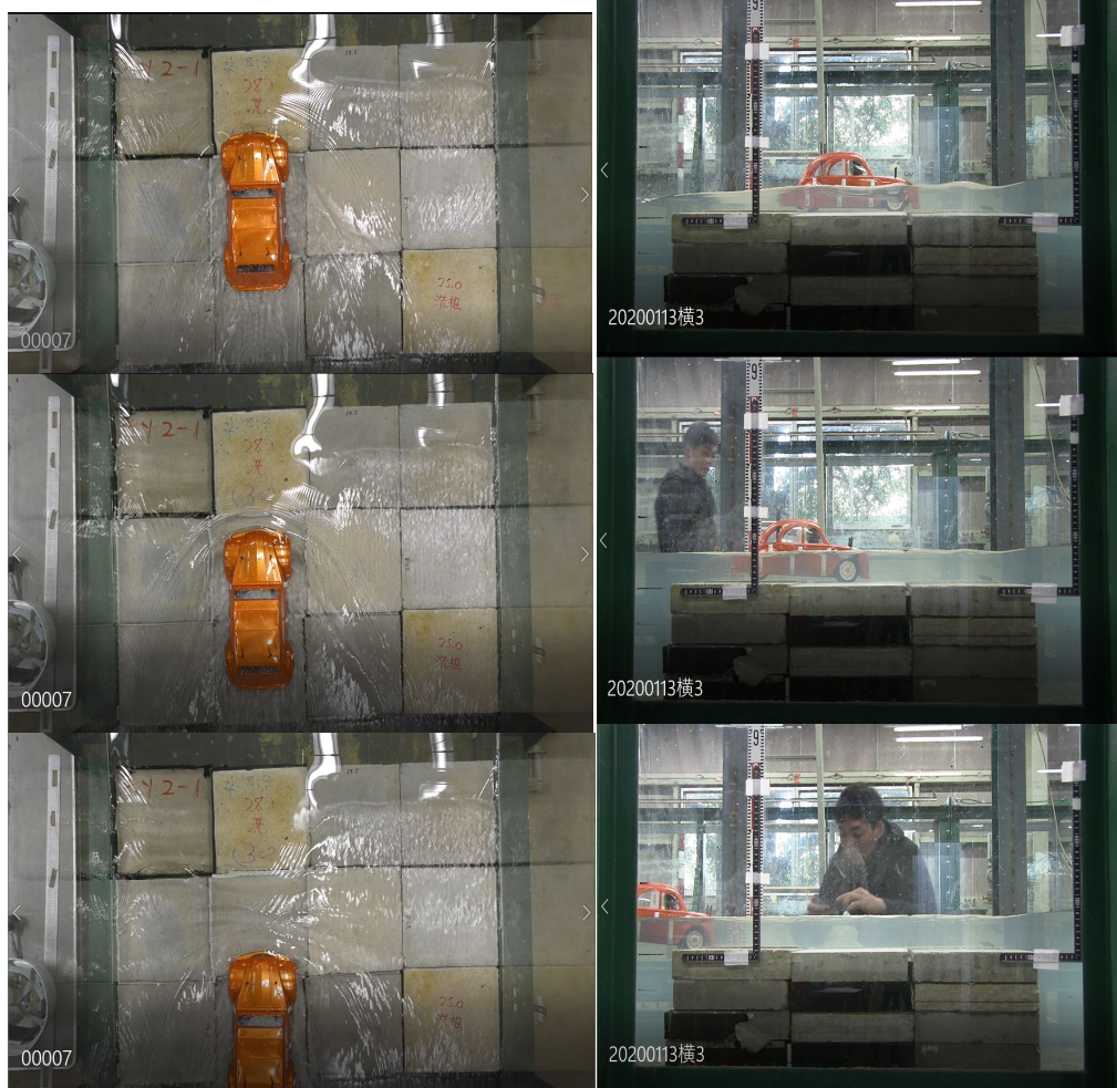
図 4-2 車両漂流実験（前向き 流量：0.020m 3 /s, 下流堰：27cm）の様子。 左段は上から，右段は横から撮影した動画の一部。
