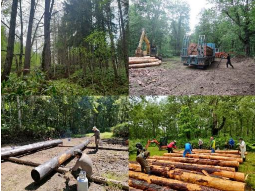
写真6 カラムツ丸太の皮むきと焼き入れ作業 左上から時計回りに、町有林、木材の運搬、皮むき作業、焼き入れ作業。
