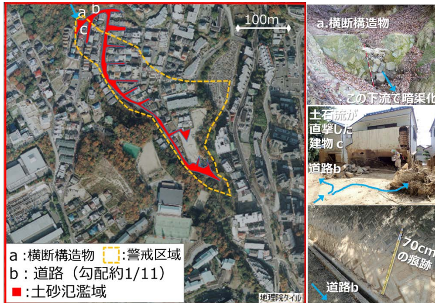
図3.2 篠原台での土石流氾濫域（左、地理院タイルの航空写真に加筆）と谷出口付近の状況（右）
