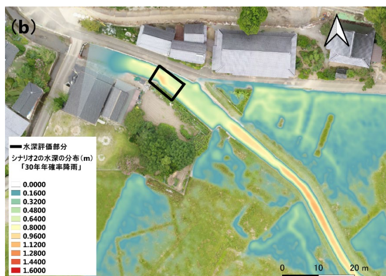
図 23 シナリオ 2 におけるピーク流量直後の水深の分布. a) は計算対象領域全体, b) は下流端周辺の水深分布をそれぞれ示す.
