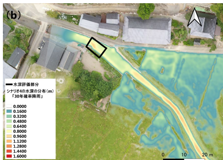
図 25 シナリオ 4 におけるピーク流量直後の水深の分布. a) は計算対象領域全体, b) は下流端周辺の水深分布をそれぞれ示す.
