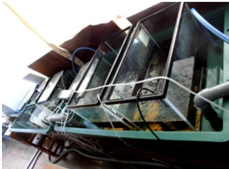
図4.26 水槽に定期的に水道水を流す装置
