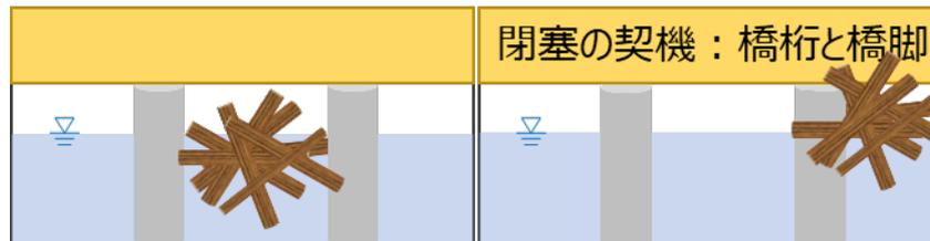
図 3.6 橋脚有り橋梁での橋脚間契機（左）と橋脚と橋桁を契機（右）にする流木の閉塞
