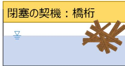
図 3.5 橋脚有り、ワンスパン橋梁での橋桁契機にする流木の閉塞
