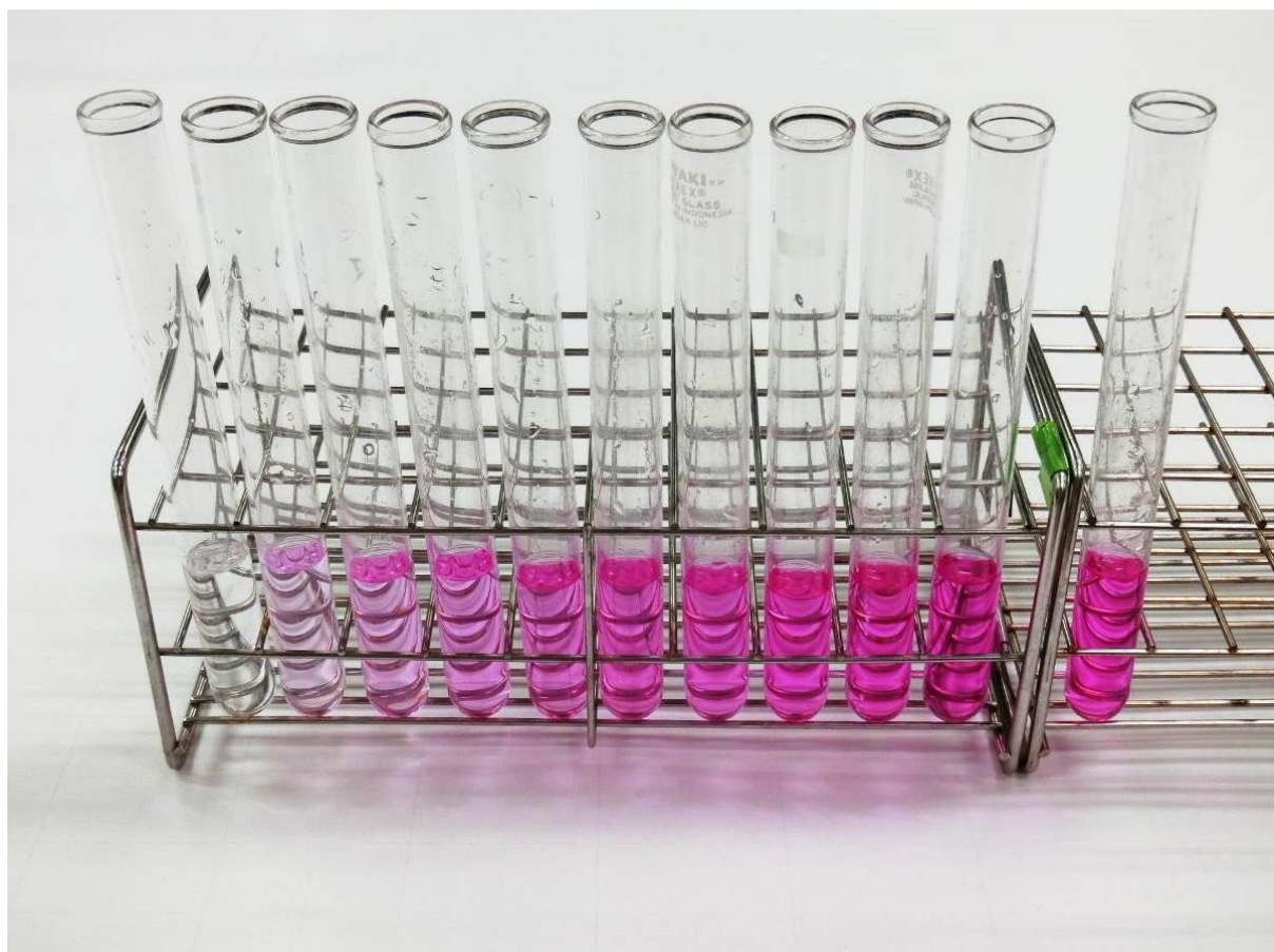
図 亜硝酸態窒素の比色分析による標準色列（2017.7.18 児童による分析結果）
