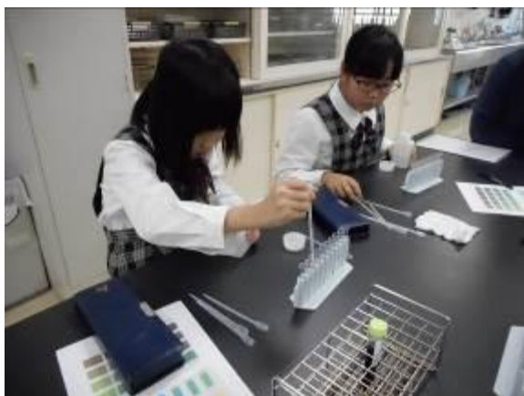
図 2.2-6 多くの比色管を並べて BTB, PR, TB などの指示薬を使い分けて pH 測定をしている。
