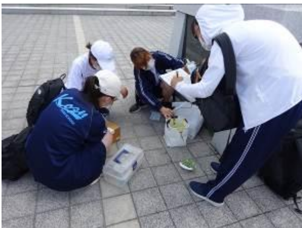
図 16 pH や電気伝導度の測定
