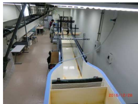
図 2-4-3 木管の水理模型実験 (金沢大学にて)
