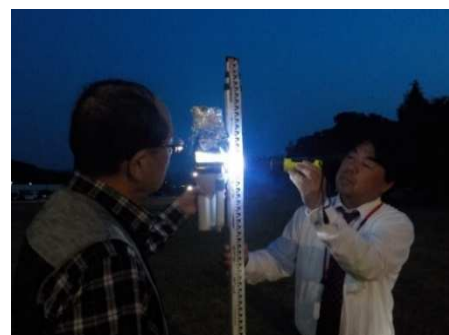
図 2-3-1 対岸の明かりの高さを読む
