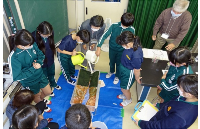
(写真11) 土壌の違いによる保水力実験
