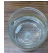
写真 15-1 2週間後（河川水）粉々に 写真 15-2 4週間後 写真 15-3 5週間後
