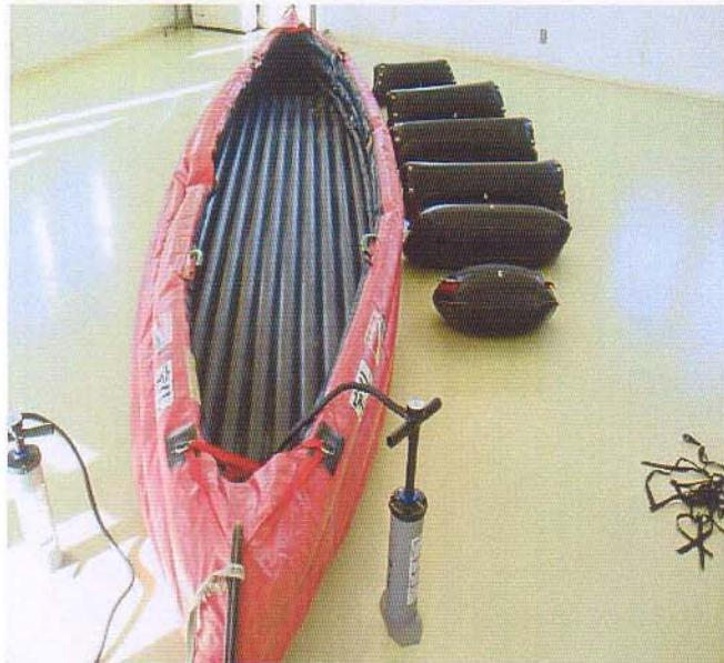
6) 両サイドに半分ぐらいい空気が入ったところで、シートをセットします。取り付け方は、シート本体に付いている、はと目穴とEポート本体の、はと目穴を重ねた状態で付属のシート固定用ベルトを上から下に通して取り付けます。シートのサイズは前から 74cm、98cm、105cm、105cm、92cm、58.5cm です。船体のカーブに角度を合わせるようにセットしてください。
