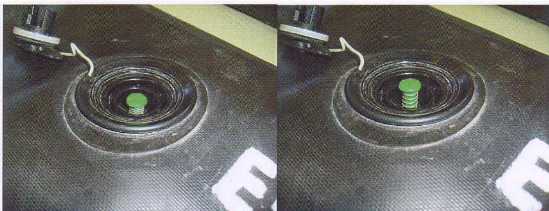
3) ポンプのホースの先端に、ポンプに付属の専用のプラグ（フラットバルブ用アダプター）を差し込みしっかりと取付けます。次にプラグをバルブに差し込み、右にひねって固定します。
