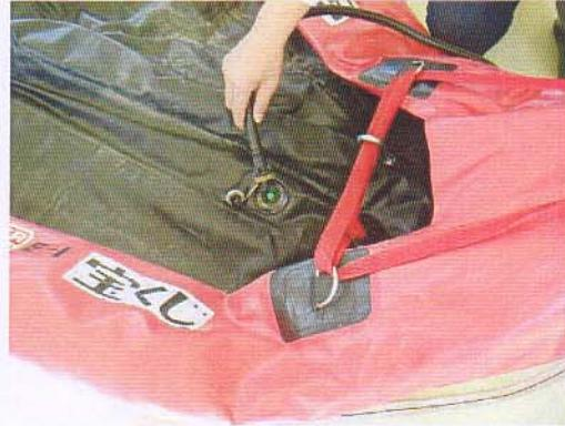
2) 内蔵フラットバルブ中央のツマミ（スプリングロック）を押し、90度回して、バルブを閉じた状態にします。ツマミが5ミリ程上がっていればOKです。下がった（開いた）ままで空気を入れても、抜けてしまいますのでご注意ください。
