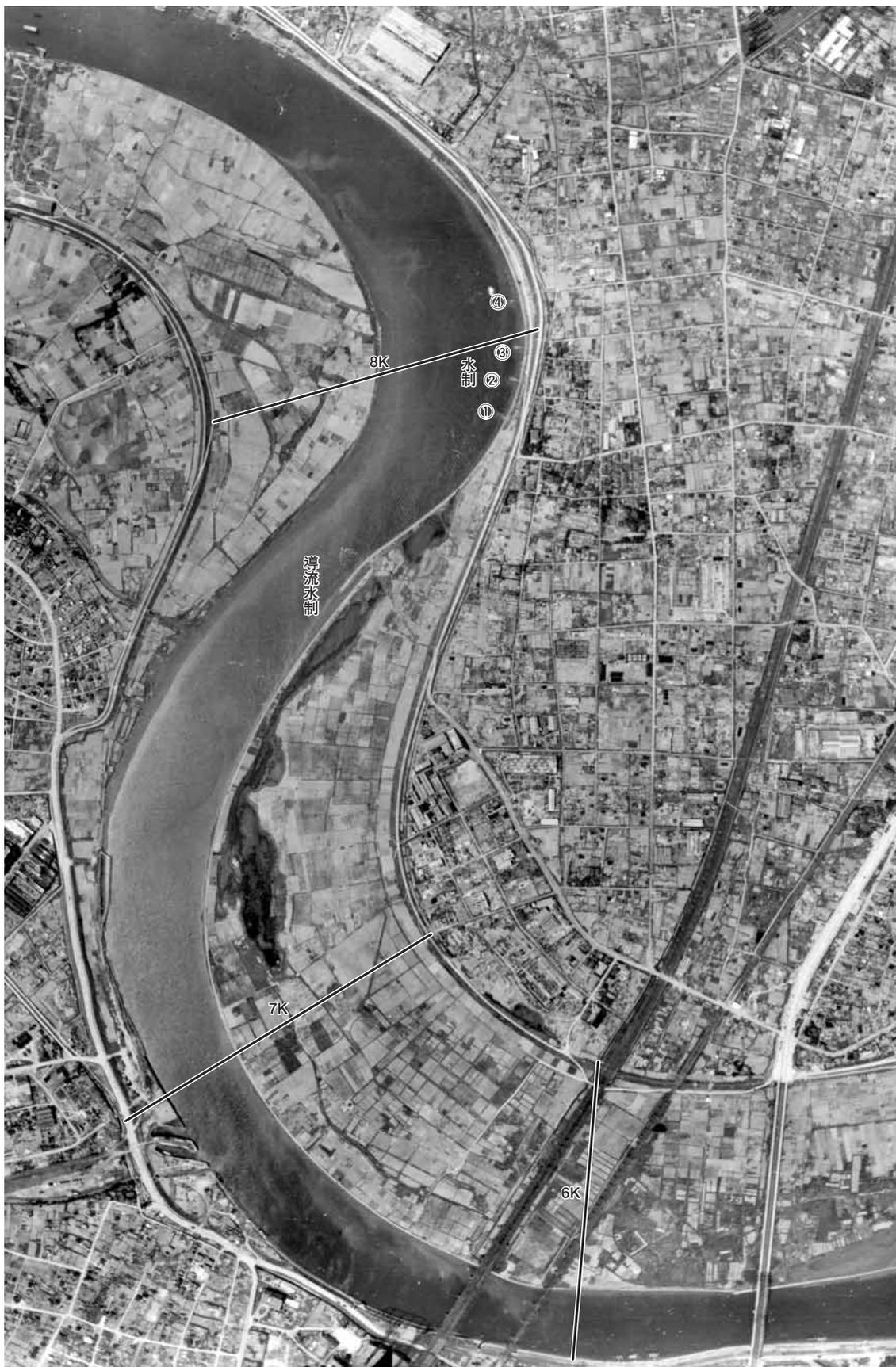
写真1.2 多摩川5.5K~8.5K地点の護岸と水制 (1947年)
