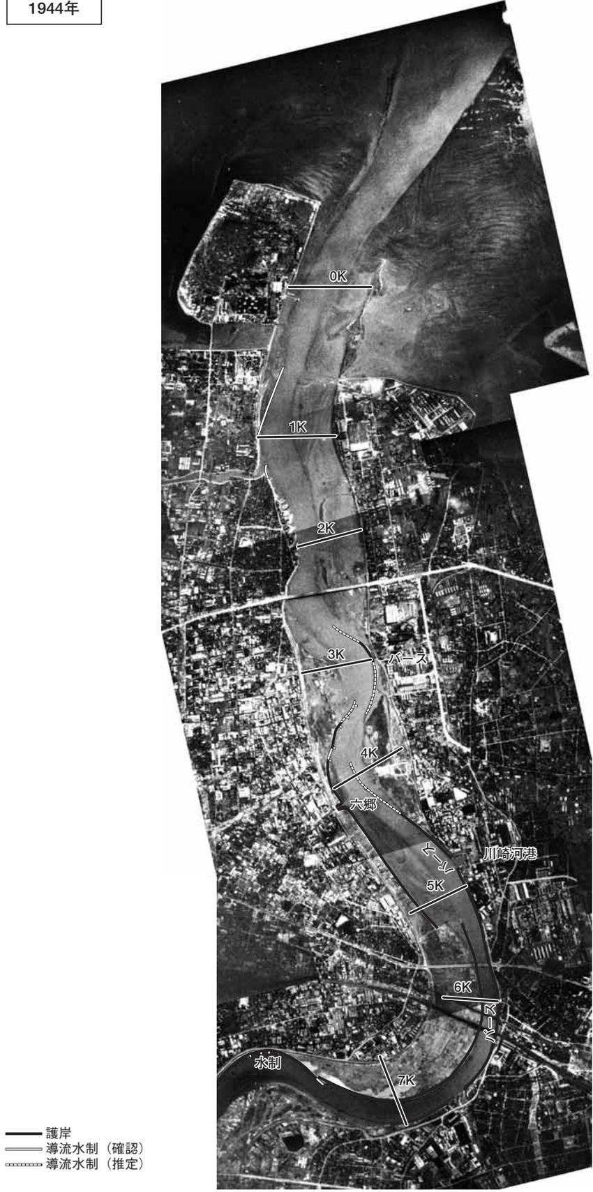
図2.15 多摩川下流改修直後の護岸、水制推定配置図 (基図1944年)
