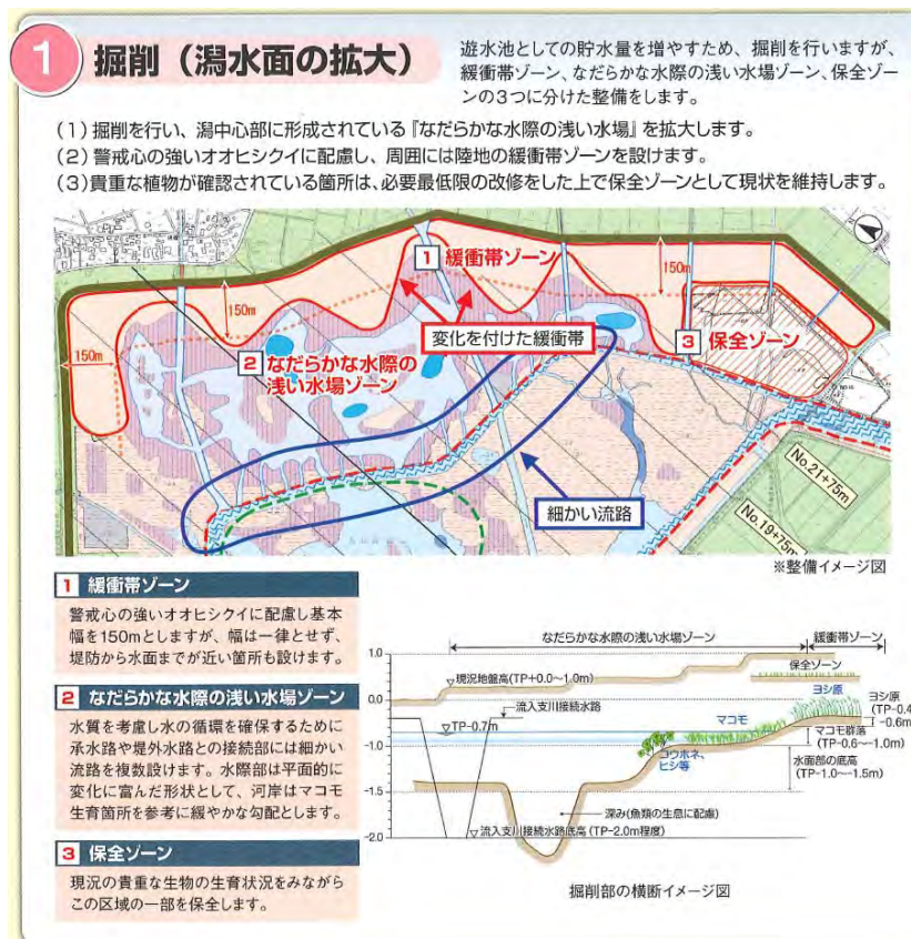
図 3.13 環境に配慮した施工（掘削） 2
