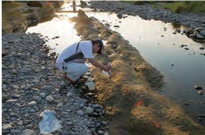
写真4.3.6 豊水期は水面下となる箇所の針貫入試験実施箇所
