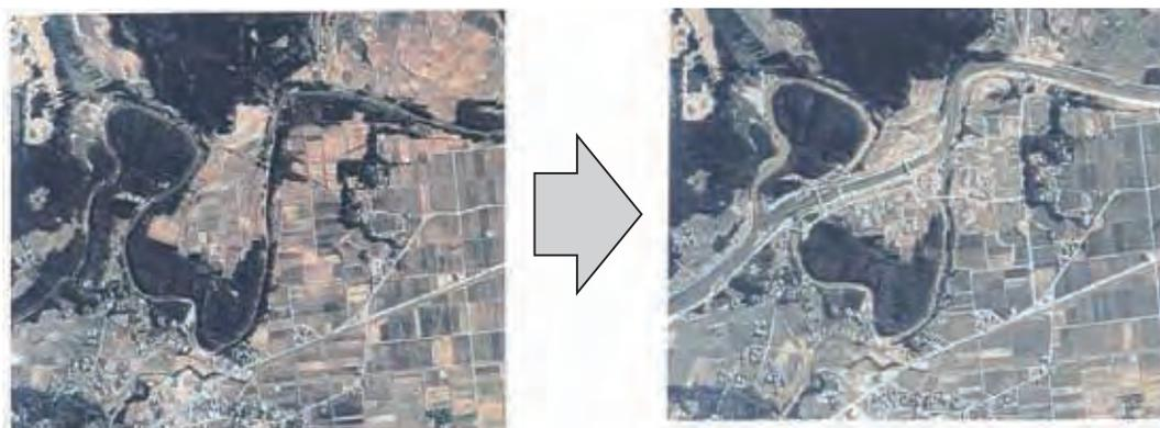
図2.5.2.1 蛇行部の改修前後の河道状況(養老川河川整備計画,2009)
