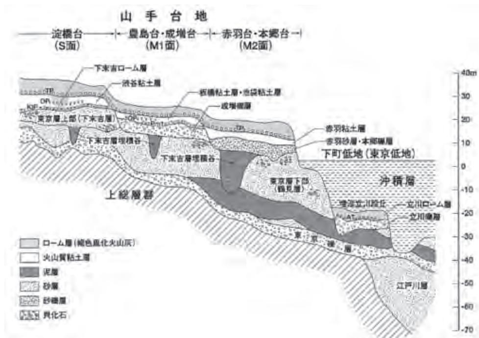
図3.5.3 武蔵野台地の模式的な地質断面図, 三谷(2002)を参考に作成(日本地質学会編, 2008)
