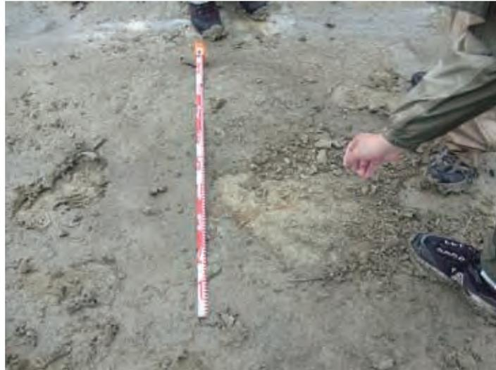
写真4.1.8 多摩川42.4km:降雨後の下部更新統の泥岩の泥濘化(左側の凹部は足跡)(2009年6月)
