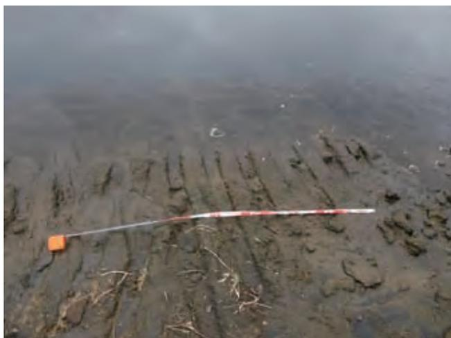
写真2.7.2.5 43.5km左岸の更新統の砂層の水際部溝状侵食:河岸からの浸透水が関係すると判断(2009年12月)
