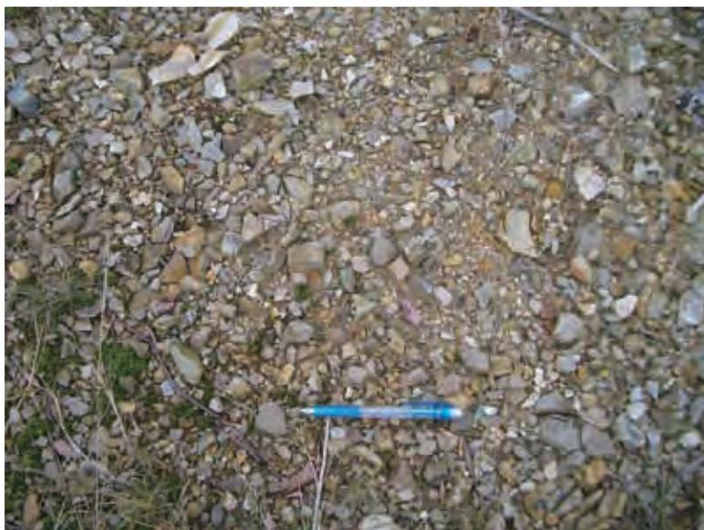
写真2.6.2.2 椿川流量観測地点の直上流右岸河床付近の泥岩の風化状況(2008年11月)
