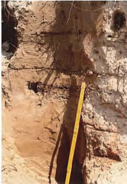
写真2.3.3.6 秋ヶ瀬橋上流35km付近,左岸水路際, 線の入っている所が泥質の堆積物(1981年)
