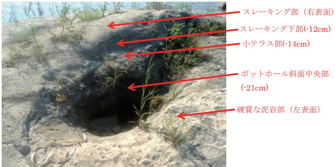
写真4.3.3 水際部のポットホール跡と測定位置
