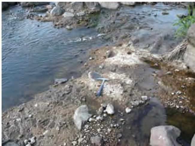
写真3.1.6 巨礫を含む火山礫凝灰岩(余笹川11.7km)(2009年5月)
