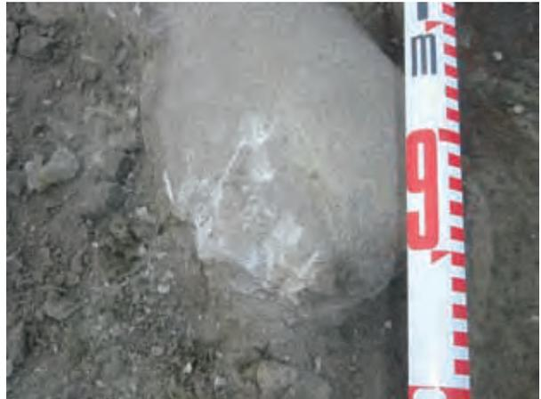
写真2.2.5.12 侵食にとりのこされた硬質な厚さ15cmの細砂混じりシルト岩(動いていない)
