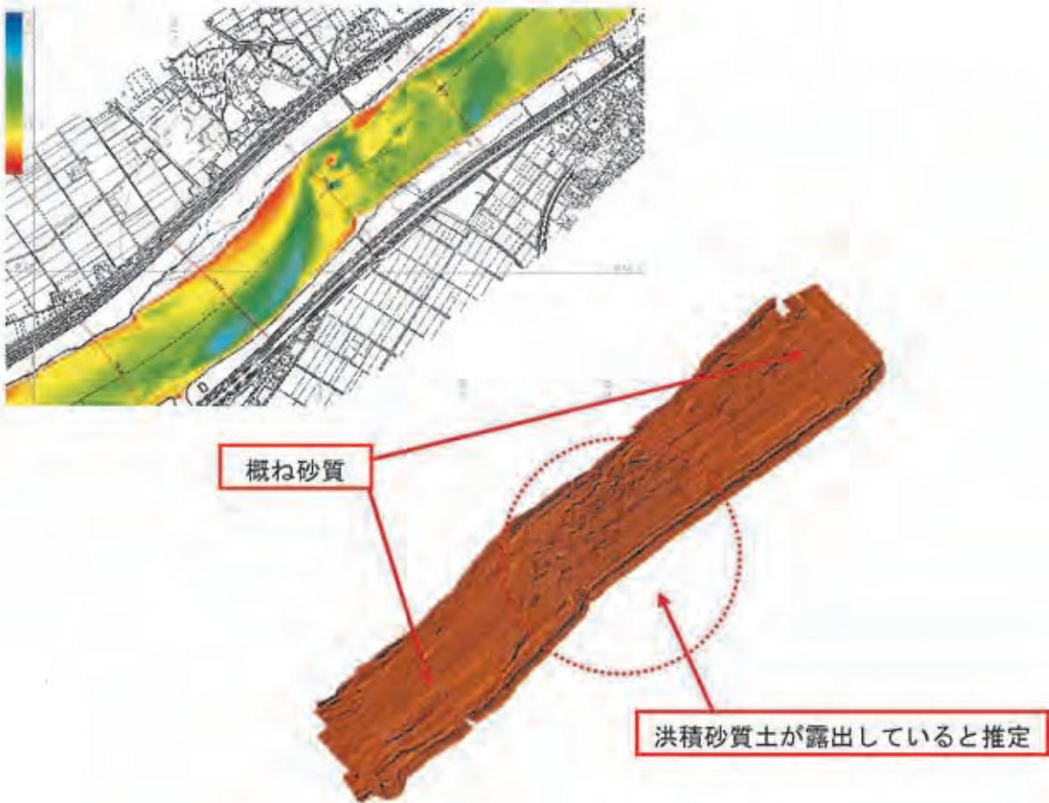
図3.3.10 サイドスキャナーによる水深分布および反射強度イメージ図(株アーク・ジオ・サポート提供)
