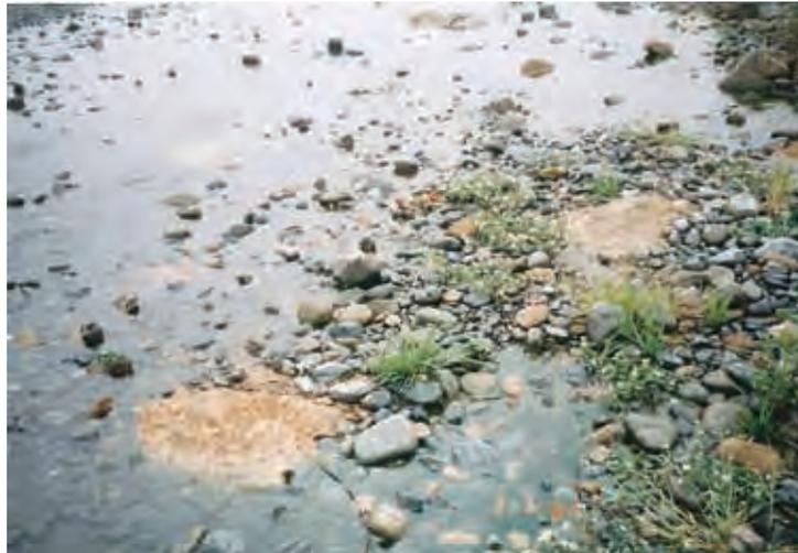
写真4.1.10 運ばれた更新統泥岩のスレーキングによる泥化(多摩川52.9km付近, 2009年6月)
