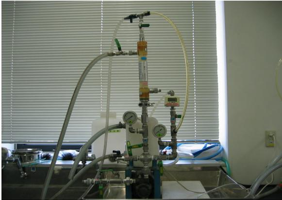
写真 - 8 膜ろ過試験機
