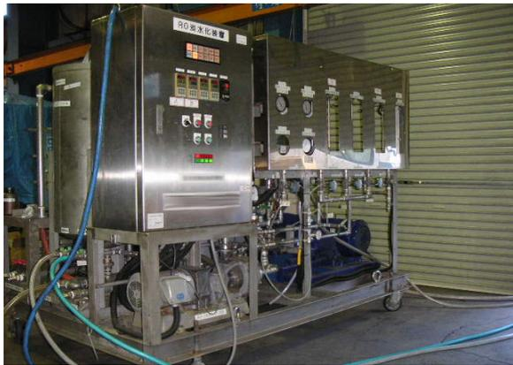
写真 - 10 RO膜ろ過試験機（前面）
