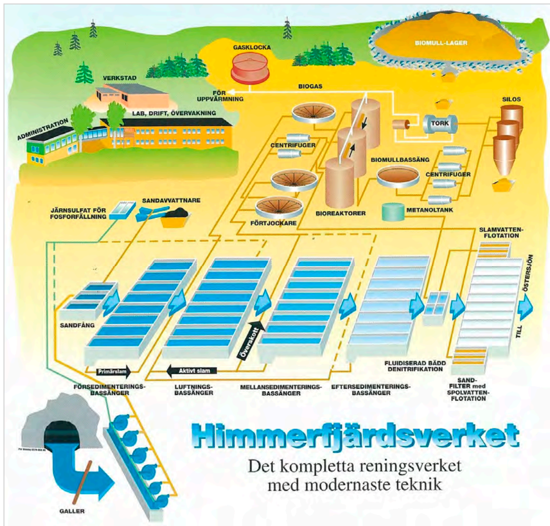
図-4.2 下水処理工程
