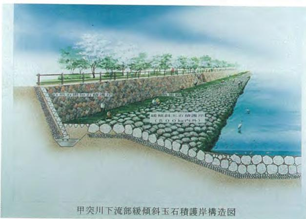
甲突川下流部緩傾斜玉石積護岸構造図
