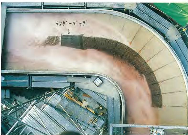
写真4・1 テンダーバッグの護岸効果確認実験
