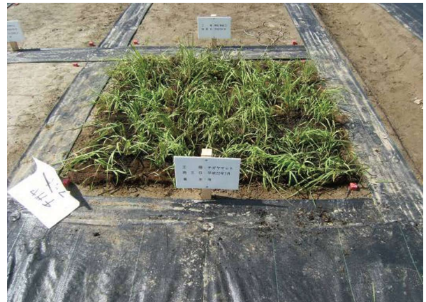
写真3 植生マット工
