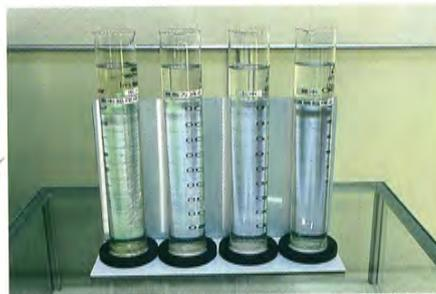
●高度処理された下水「麗水(れいすい)」。左から二次処理水(一般的な下水道処理場で処理された水)、水道水、麗水。
