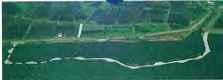
写真⑤ 霞ヶ浦へのリンや浮遊物質の流入を防ぐために、川尻川河口に整備された湖内湖。湖沼に流れこむ川の河口に人工湖(湖内湖)をつくり、川から流れ出すリンや浮遊物質をそこにためて、湖の水質をまもる。リンや浮遊物質がたまった湖内湖の底泥は数年一度とりのぞく。
