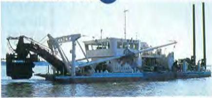
写真④ 茨城県霞ヶ浦の水質浄化に活躍する浚渫(しゅんせつ)船「カスミザウルス」。霞ヶ浦では、湖の底にたまった泥(底泥)から溶け出すチッソとリンが非常に多い。そこで浚渫船を使って、泥を湖底からさらい(浚渫して)チッソとリンを除去している。泥は低地水田のかさ上げに利用されている。
