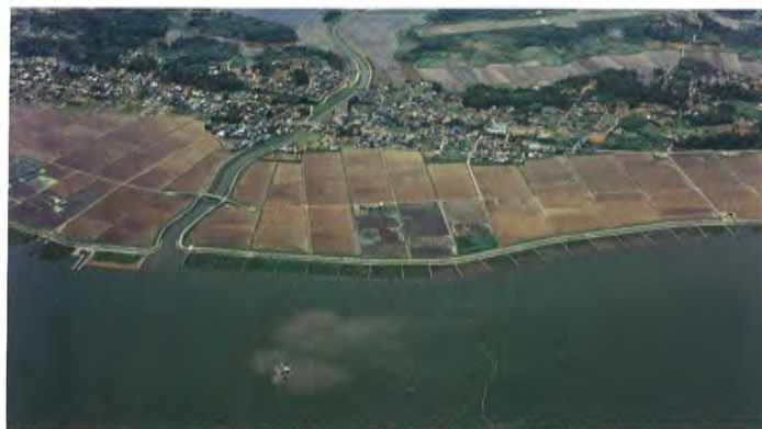
●(上)空中から見た清明川浄化施設。湖水にヨシ原が広がる [写真提供：建設省関東地方建設局霞ヶ浦工事事務所] ●(左)清明川の水は水路からヨシ原を通り、霞ヶ浦に流れこむ
