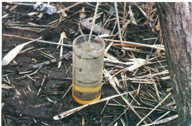
写真 3・4 簡易円筒法による最終浸入度の測定（干渴わき）
