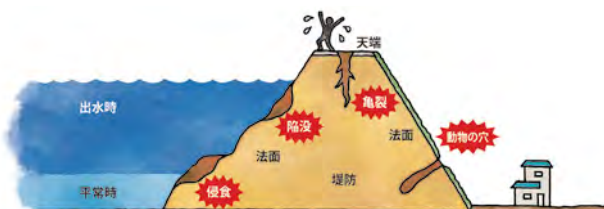
図5 堤防点検で発見された変状がどのような影響を及ぼすのかを表現したイラスト
