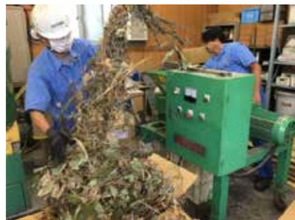
図 2-4 破碎機による堤防刈草の破碎
