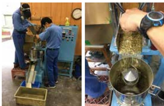
図 2-6 ペレット製造機による堤防刈草のペレット化
