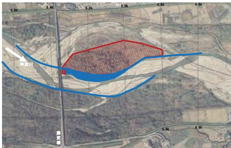
凡例 低水路の掘削 樹林伐採・抜根、表土はぎとり(低水路形成範囲外)
