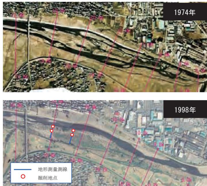
図5.5.16 河岸堆積物調査箇所の堆積状況
