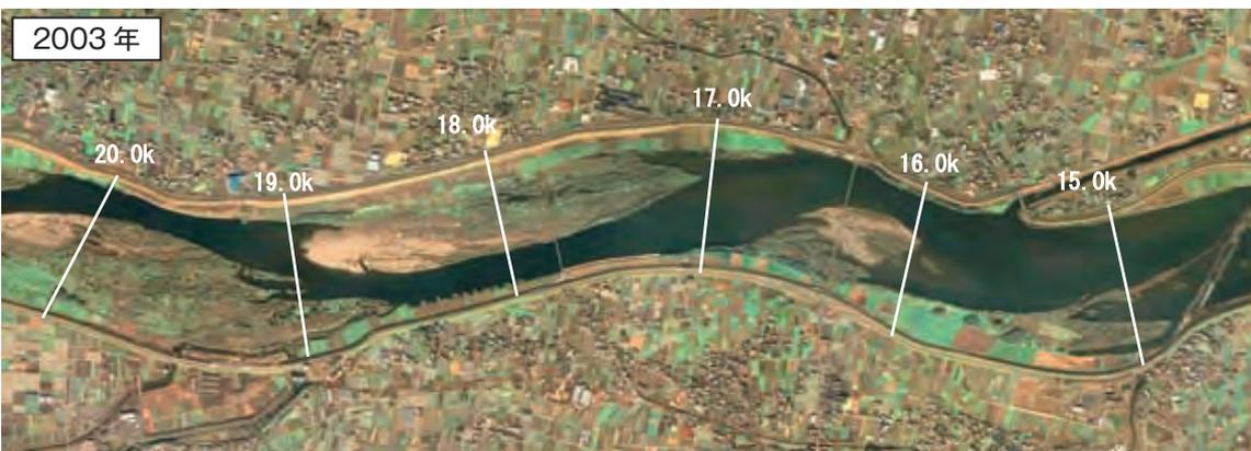
図5.6.12 平面形状の経年変化(岩津下流部)
