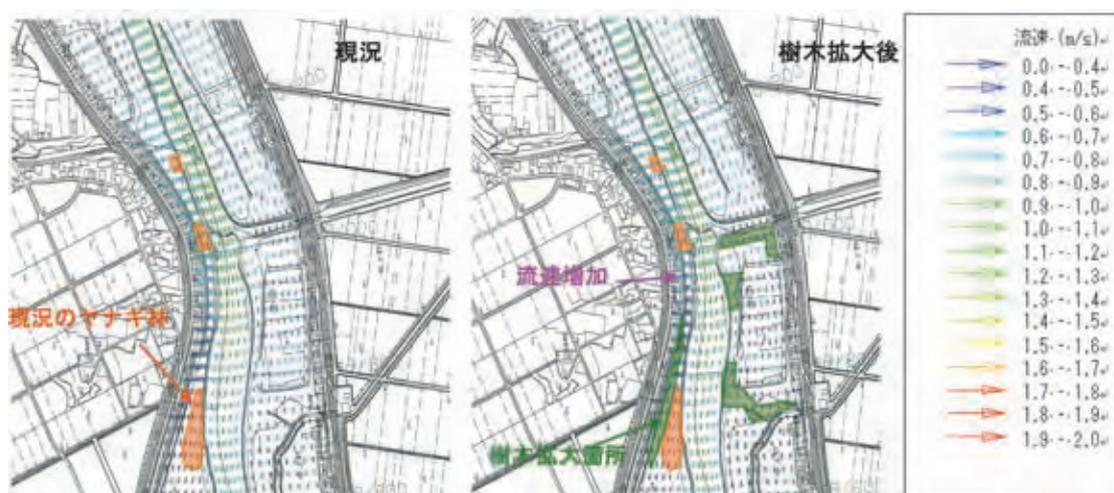
図9.3.3 樹木群の拡大による流速ベクトルの変化
