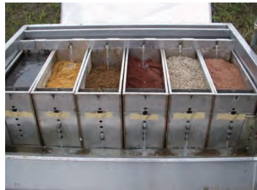
④リン吸着実験槽
