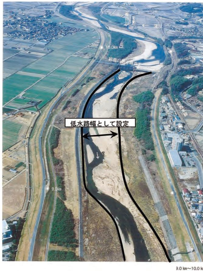
写真 3.2.1 低水路幅の設定（低水路幅は、現地の植生繁茂の状況および比高差の状況を考慮した。）
