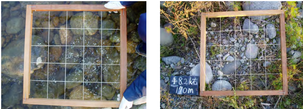
図-参 2.4 代表粒径の把握のための写真撮影 (土壌調査 c))
