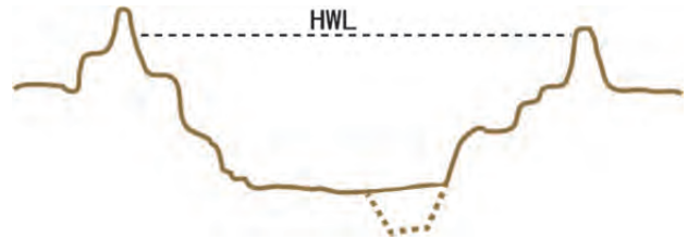
図 3-7 平坦型+溝型の河床低下
