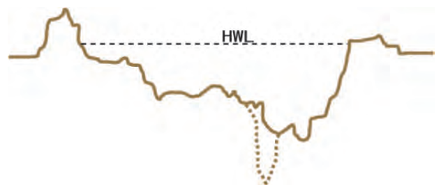
図 3-8 急激な河床低下型
