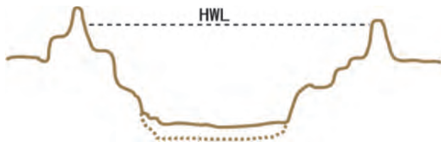
図 3-6 平坦型の河床低下
