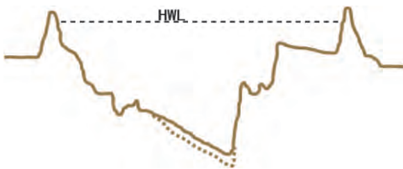
図 3-5 逆三角形型の河床低下
