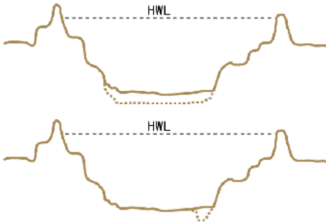
図 3.4 平坦型の河床低下模式図
