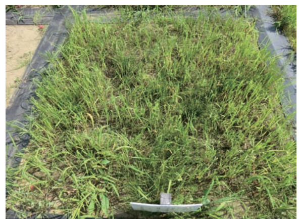
写真 4・24 H23年3月施工植生マット工 4カ月後(10cm程度に除草後[除草前草丈80cm])
