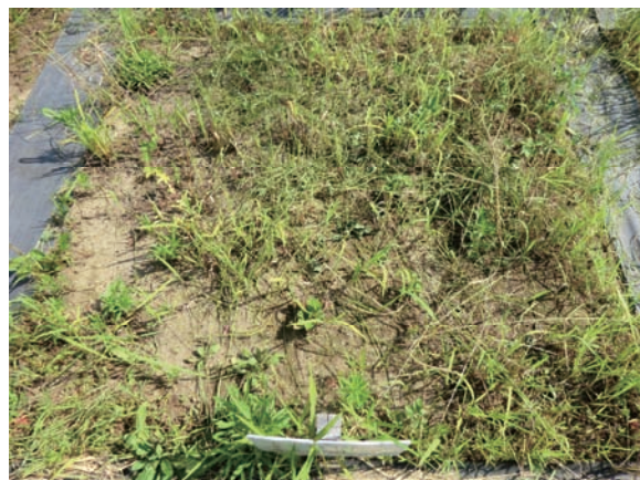
写真 4・18 H22 年 7 月施工植生苗吹付工 1 年後 (10cm 程度に除草後 [除草前草丈 70cm])
