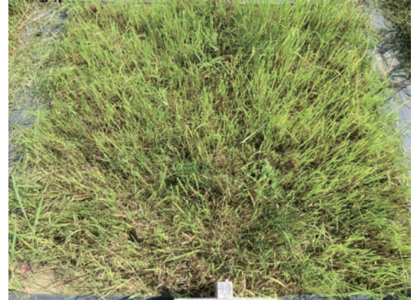
写真 4・12 H22年7月施工種子吹付工(10,000粒/m 2 ) 1年後(10cm程度に除草後 [除草前草丈50cm])
