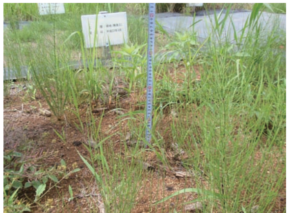
写真 4・19 H23 年 3 月施工苗吹付工 3 カ月後 (草丈 27cm)
