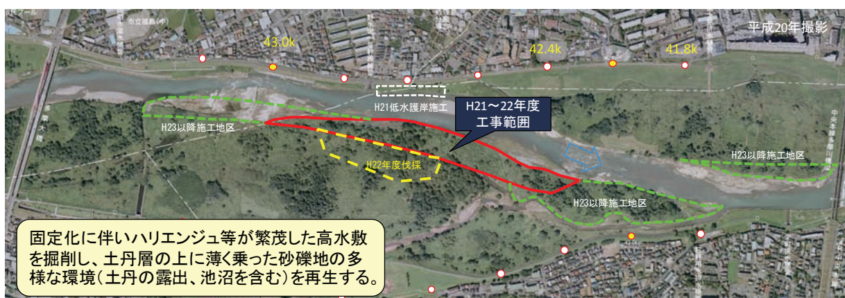
図1・1 当該地区の自然再生工事施工範囲
