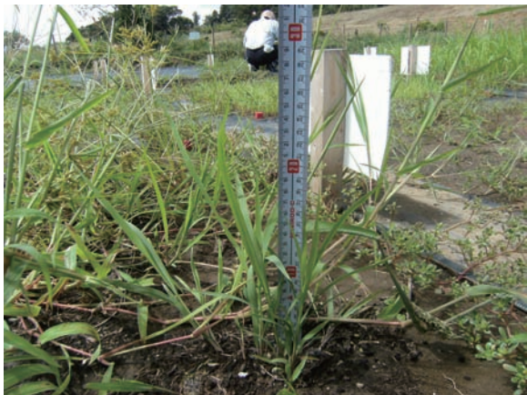
写真 4・17 H22 年 7 月施工苗吹付工 7 週間後 (草丈 25cm, 雑草に覆われている)
