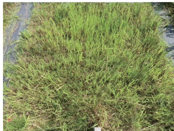
写真 4・8 H22年7月施工種子吹付工(5,000粒/m 2 ) 1年後(10cm程度に除草後[除草前草丈50cm])
