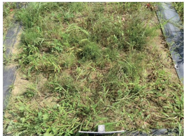
写真 4・20 H23 年 3 月施工苗吹付工 4 カ月後 (10cm 程度に除草後 [除草前草丈 60cm])
