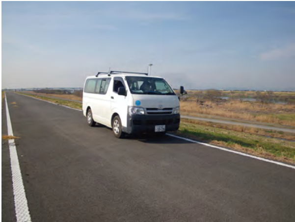
写真4・2 GPS 車載による堤防高計測の様子
