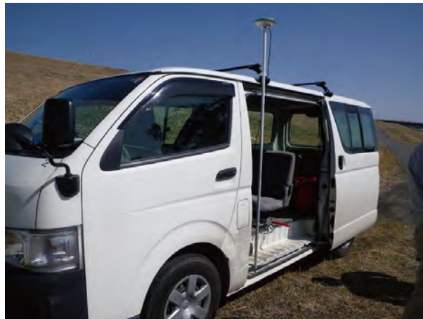
写真 4・1 GPS の車載設置状況
