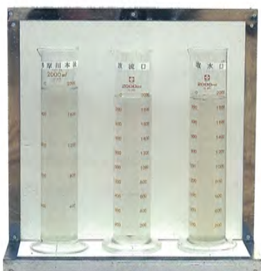
上の写真のように浄化後の水、平瀬川の水、多摩川の水を底に黒い「十字」の描かれたメスシリンダーに入れ、真上から「十字」をながめて水質を比較。左および下の3枚の写真は、カメラがとらえた「十字」の像。
