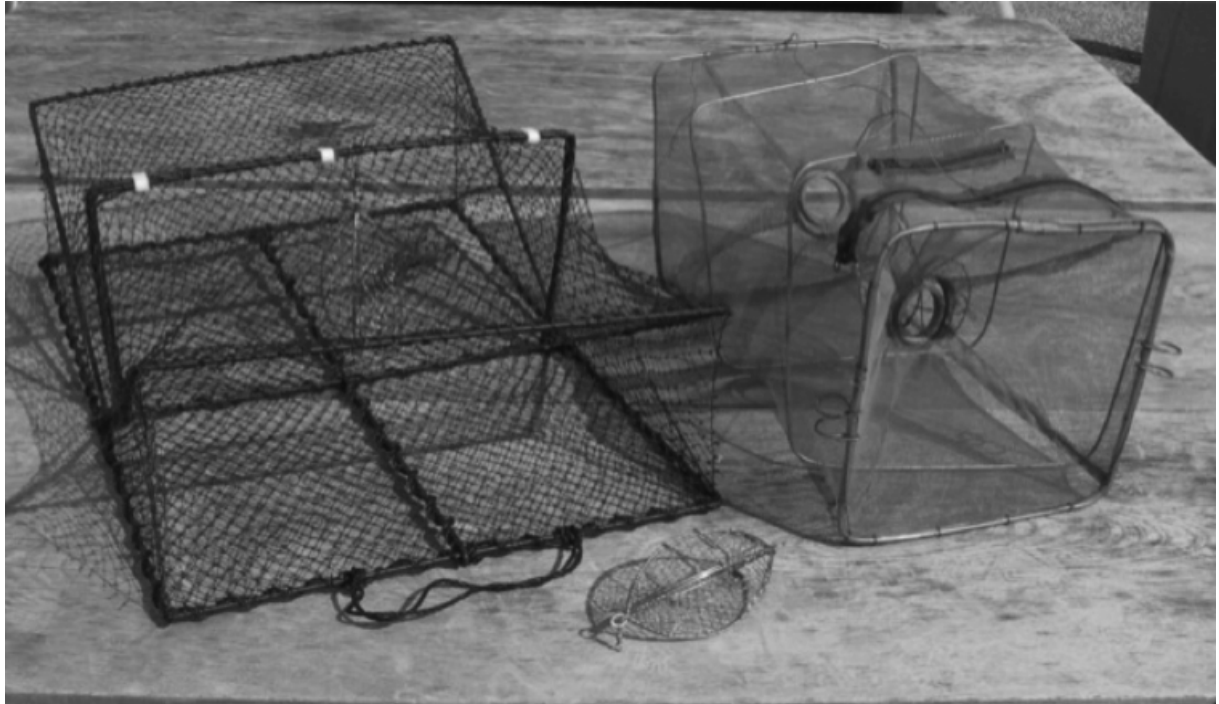
図 1. カニ籠 (左) とエビ籠。(お魚キラー、右). エビ籠の出入り口には直径 4cm のリングを取り付けている. 手前はエサを入れるステンレスアンドン籠.
