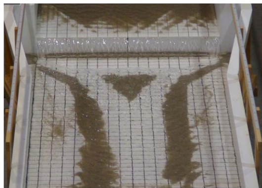
図-21 通水後の落差工下流部での砂の堆積状況
