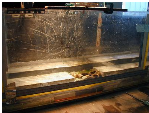
写真2-9. コンクリートブロックの間に河川から採取した礫を設置した水路 (下流から2.7m~3.0m)
