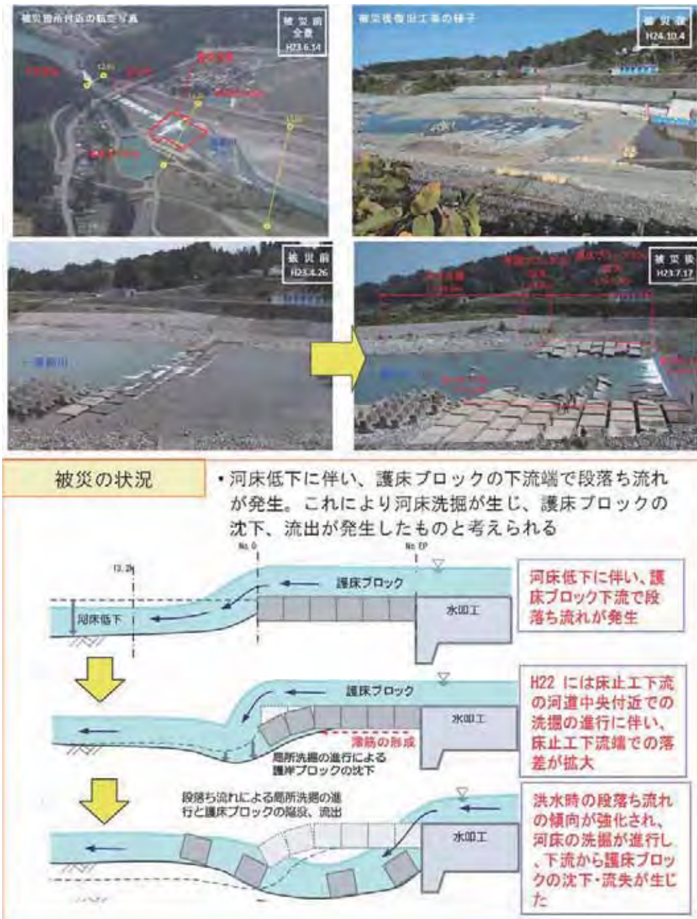
図 6.4.3 愛本床止め護床工被災の状況
