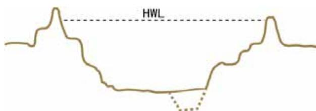
図 3-3 平坦型一部溝化の河床低下模式図
