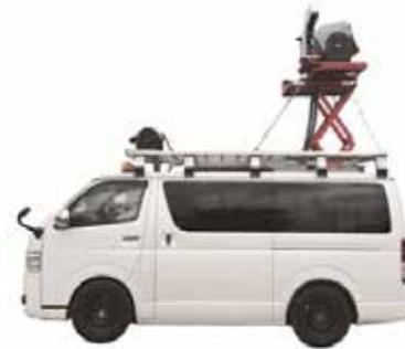
図 4-1 移動計測車両の一例
