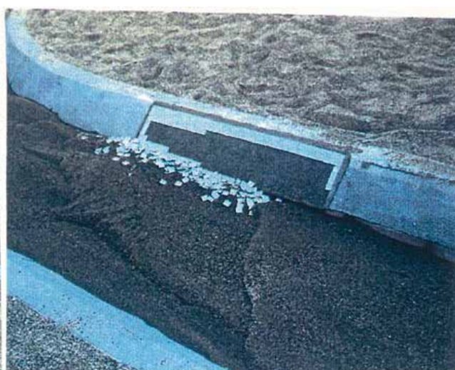
写真-8 法勾配1割法留工, 根固工なし 護岸破壊状況 ケース5 (護岸模型3)
