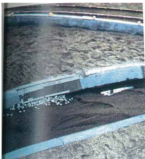
法勾配1割法留工のみ護岸破壊状況 ケース4 (護岸模型3)
