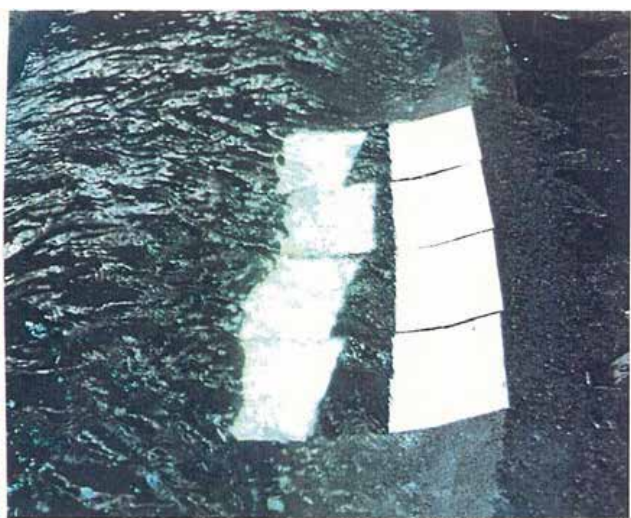
写真-4 根入れ不足護岸破壊状況 ケース2 (護岸模型2)
